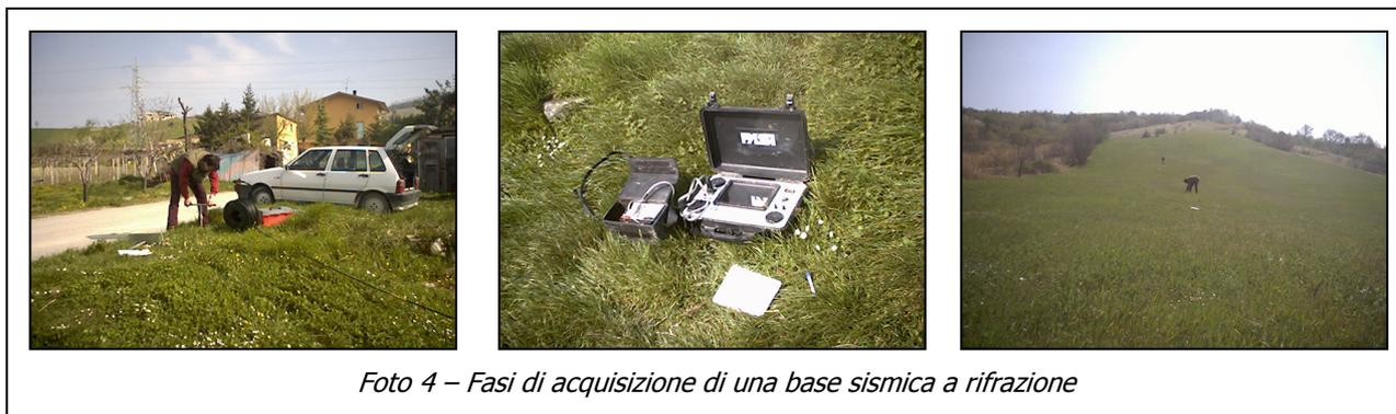
Gli impulsi sismici ricevuti dai geofoni posizionati sulla superficie topografica sono stati acquisiti utilizzando il sismografo PASI 12S12L a 12 canali di registrazione simultanea, tramite il quale, dopo amplificazione, conversione analogico-digitale e filtraggio, sono stati registrati nell'hard disk di cui il sismografo stesso è dotato.
